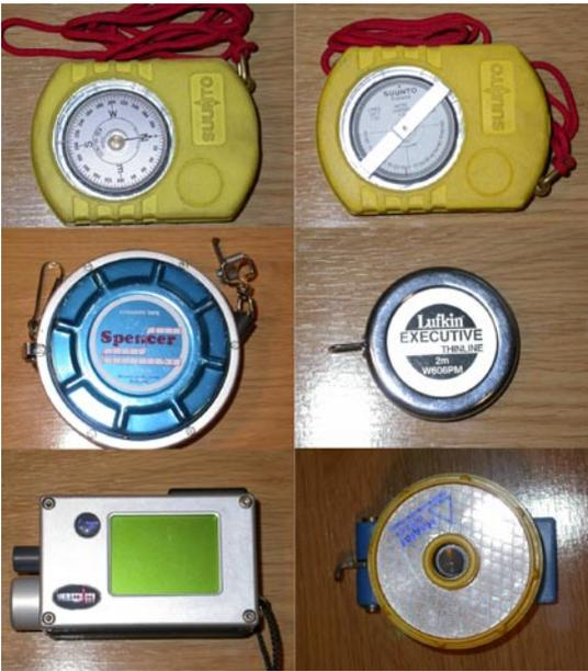
**Foto 1.** Instrumentos de medición. De arriba a bajo, y de izquierda a derecha: brújula Suunto, clinómetro Suunto, cinta métrica, cinta diamétrica Lufkin, módulo principal del hipsómetro electrónico Vertex III y módulo remoto del mismo
